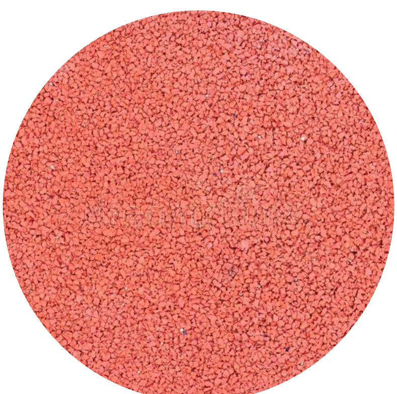
Fietsstrook Asfalt rood
